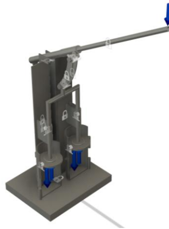
Gambar 7. Pembeban force pada tuas
