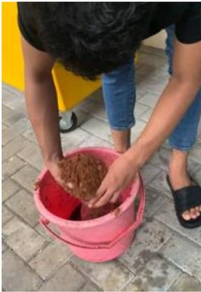
Gambar 12. Pencampuran serbuk kayu dengan air
